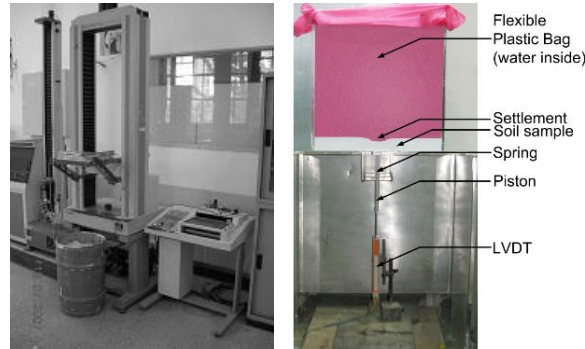
Gambar 6. Alat Uji Moving Ball Test (kiri) dan Flow Box Test (kanan) (Widjaja dan Lee, 2013)
