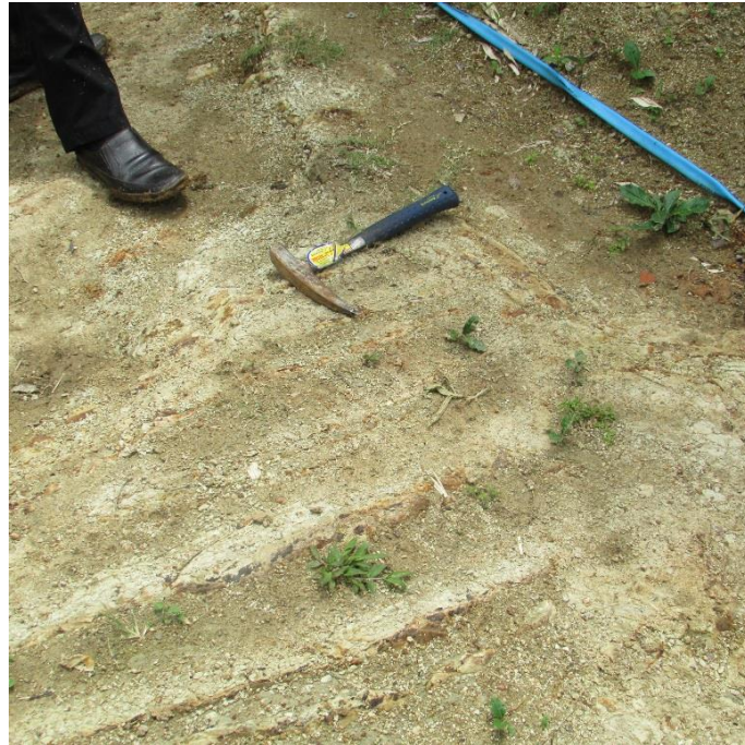
Gambar 8. Struktur seretan (dragg fold) di lokasi gerakan tanah, sebagai salah satu indikasi adanya struktur patahan.
